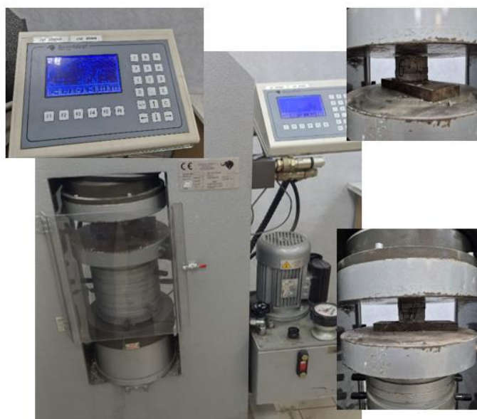
Рисунок 2.6 – Фотофіксація пресу типу KL 200/CE-Tecnotest в режимі проведення досліджень
