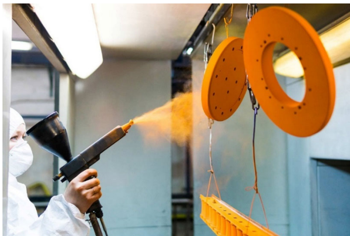
Рисунок 3.9 - Порошкове фарбування з пістолета-розпилювача
