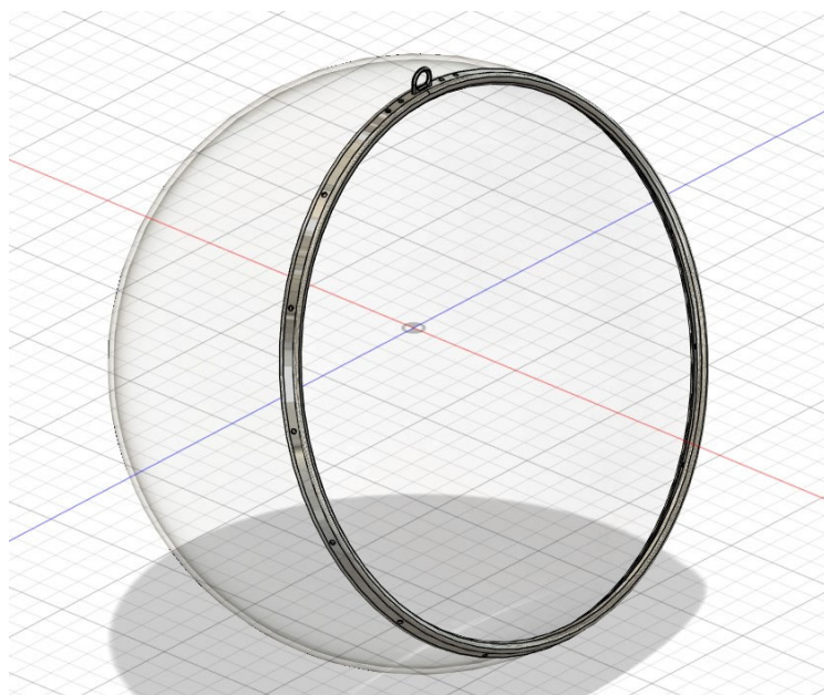
Рисунок 2.13 - Кінцевий вигляд заготовки корпусу крісла
