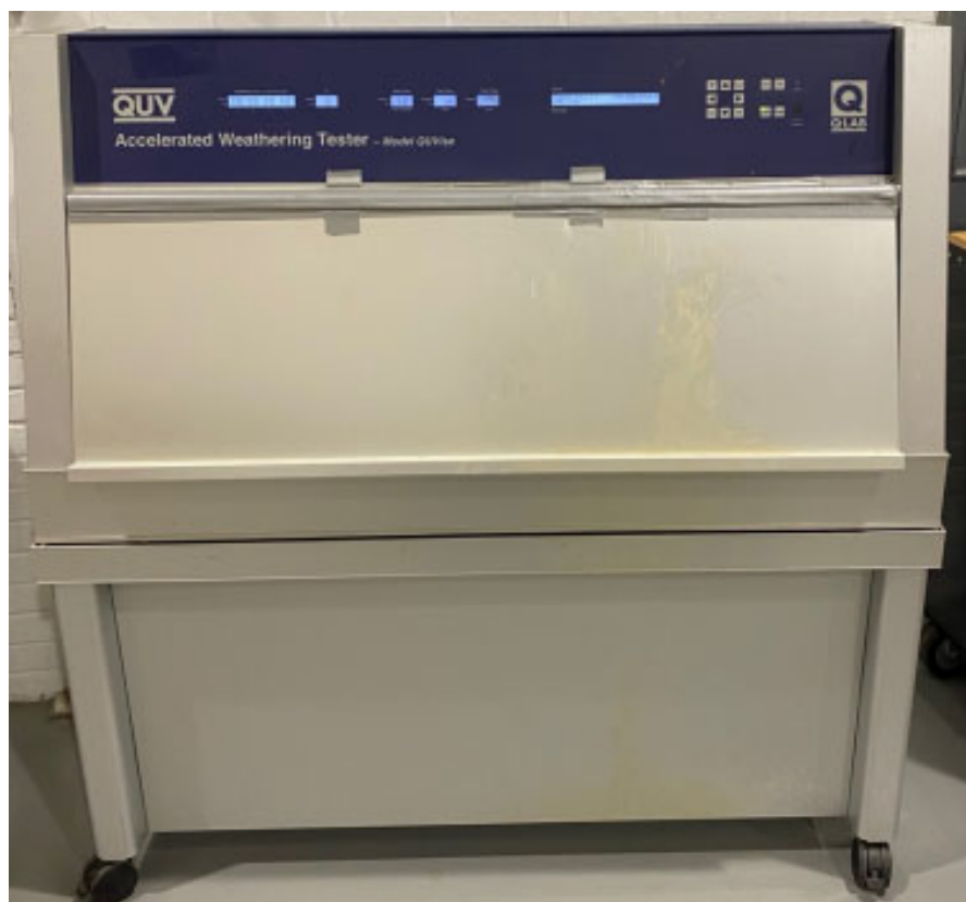
Рисунок 3.1 – Везерометр для прискорених випробувань на атмосферостійкість QUV (QUV Accelerated Weathering Tester)
