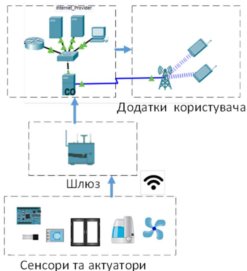
Рисунок 4.3 – Структурна схема мережі IoT
