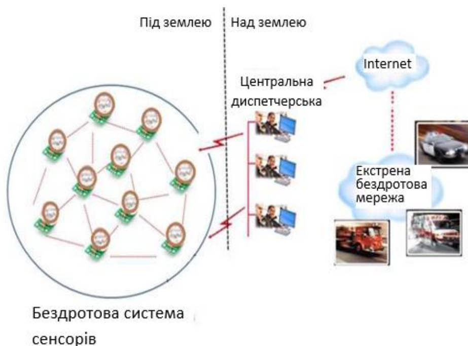
Рис. 1. Схема зв'язку між підземним і наземним середовищем в бездротовій системі моніторингу [12]
