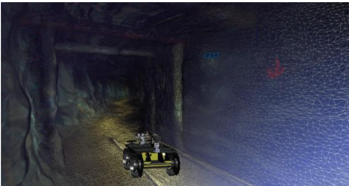
Рис. 3. Візуалізація руху робота під час сканування виробки [15]
