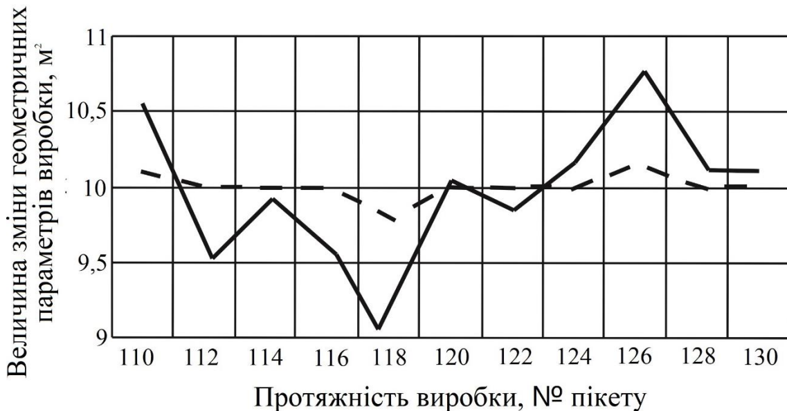
Рис. 7. Залежності зміни перерізу виробки за результатами натурних спостережень за кріпленням 148 збірного штреку шахти Ювілейна: — без раннього прогнозування (без стояків кріплення посилення); - - - - 3D-сканування й раннього прогнозування (зі стояками кріплення посилення)
