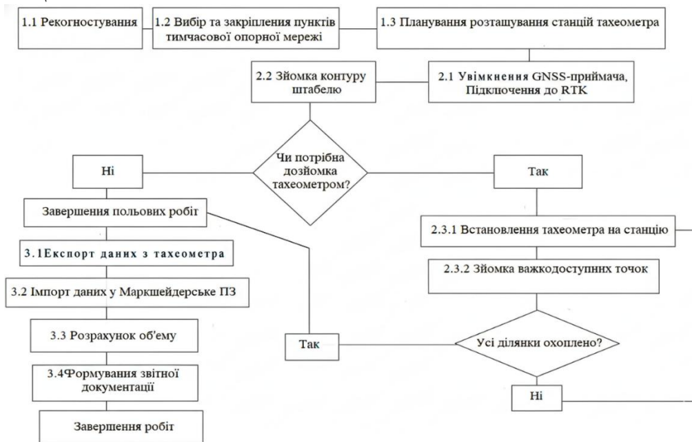
Рисунок 1 – Технологічна схема вимірювання об'єму штабелю окатишів комбінуванням тахеометричної зйомки та GNSS-вимірювань
