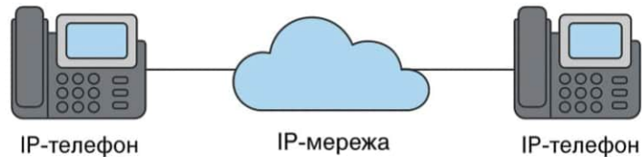
Рисунок 1.3 – Пряме підключення до IP-мережі
