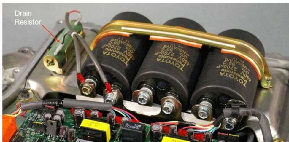
Рис. 6.16. Високовольтні конденсатори з пасивним розрядним резистором, що встановлені в реальному автомобілі
