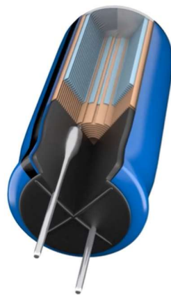
Рис. 6.14. Внутрішня будова типового електролітичного конденсатора
