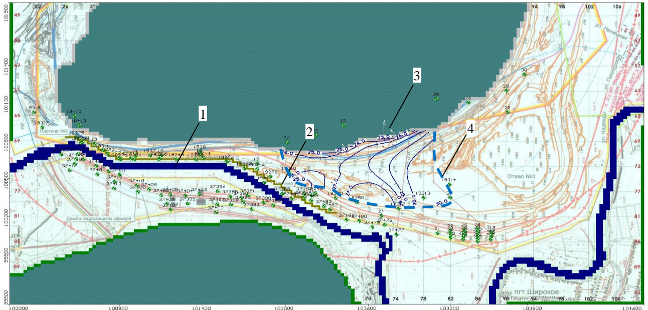
Рисунок 2.4 – Карта розрахункового положення рівневої поверхні обводненої зони породного відвалу № 3 станом на квітень-травень 2015 р. – епігноз, нестаціонарний режим фільтрації, м: 1 – існуюче положення русла р. Інгулець; 2 – ПФЗ; 3 – напрямок фільтраційного потоку; 4 – зона обводнення
