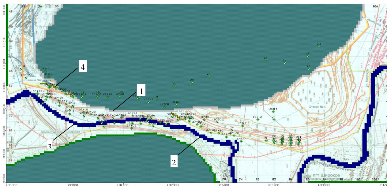
Рисунок 4.13 – Розрахункова схема до прогнозу гідродинамічного режиму алювіального водонесного горизонту при прогнозованому просуванні контуру кар'єру (на період до 25 років) за умови спорудження нового русла р. Інгулець: 1 – очікуване положення борту кар'єру; 2, 3 – відповідно існуюче і проектоване нове русло р. Інгулець; 4 – існуюча ПФЗ
