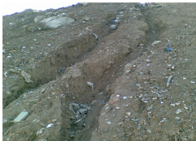
Рисунок 4.33 – Особливості будови штучних ґрунтів в межах спланованих ділянок в верхів'ї балки Ясинова
