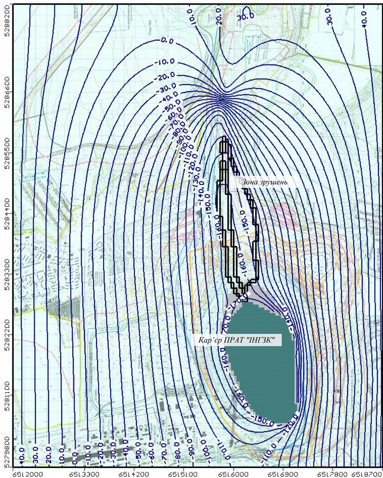
Рисунок 2.38 – Розрахункова рівнева поверхня підземних вод в тріщинуватій зоні кристалічного масиву, контур дренажу в межах північного борту кар'єру на горизонті -180,0 м, м
