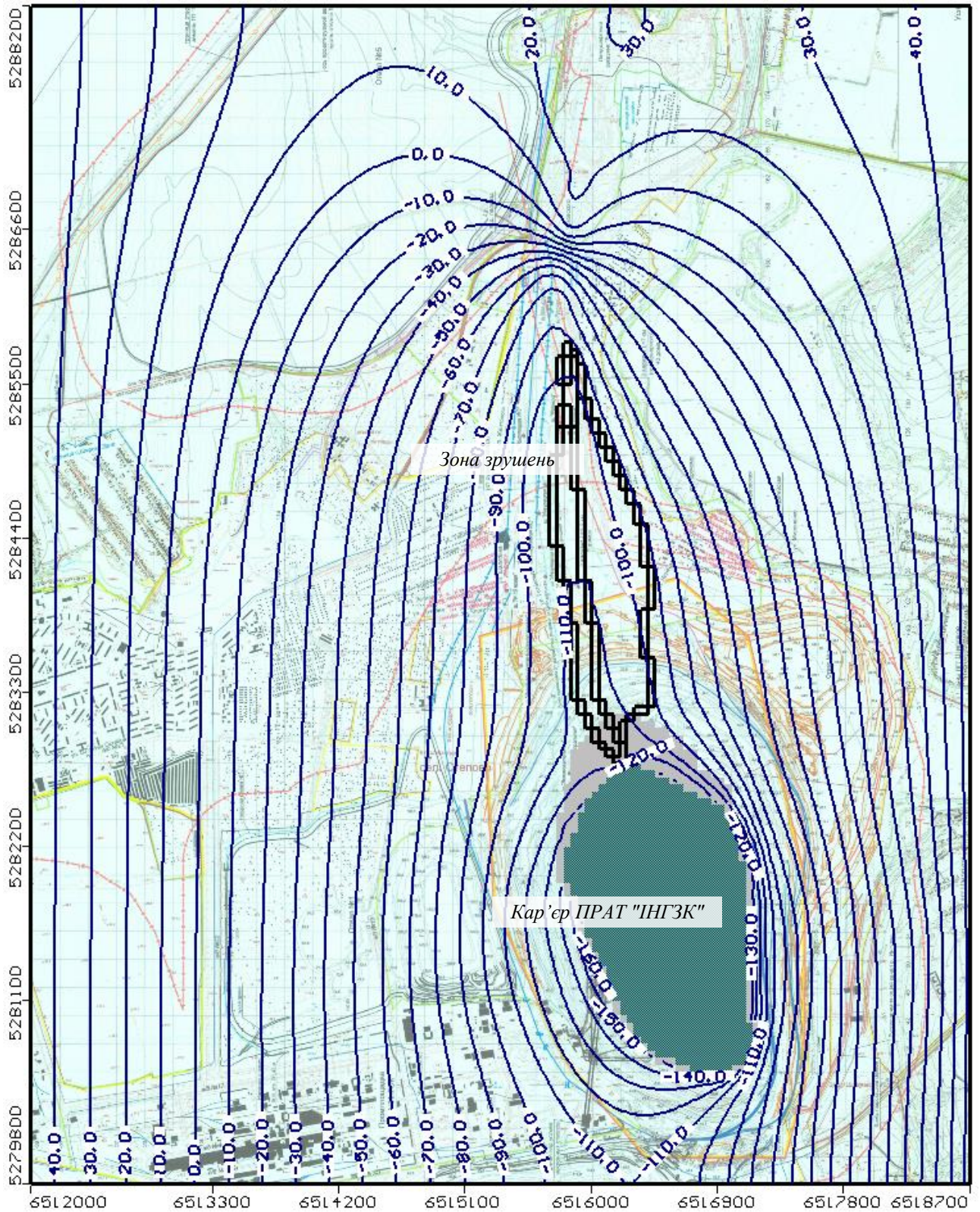
Рисунок 2.33 – Розрахункова рівнева поверхня підземних вод в тріщинуватій зоні кристалічного масиву станом на початок 2017 р., м
