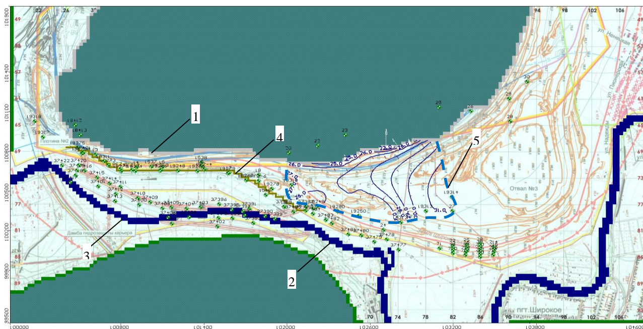
Рисунок 4.15 – Рівнева поверхня обводненої зони відвалу № 3 при проектованому положенні нового русла р. Інгулець: 1 – існуюче положення борту кар'єру; 2, 3 – відповідно існуюче і проектоване нове русло р. Інгулець; 4 – існуюча ПФЗ; 5 – зона обводнення
