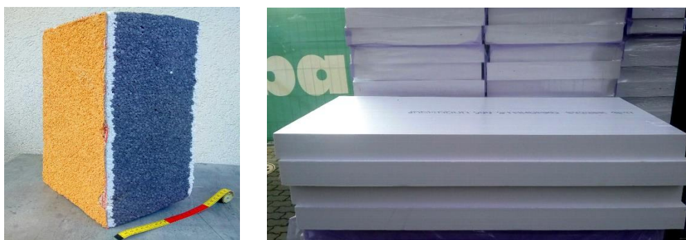
Рисунок 1 – Пінопластові утеплювачі фасадних стін: ліворуч – з екструдованого полістиролу; праворуч – у вигляді конструктивних елементи товщиною 160 мм з уступами висотою 80 мм по периметру
