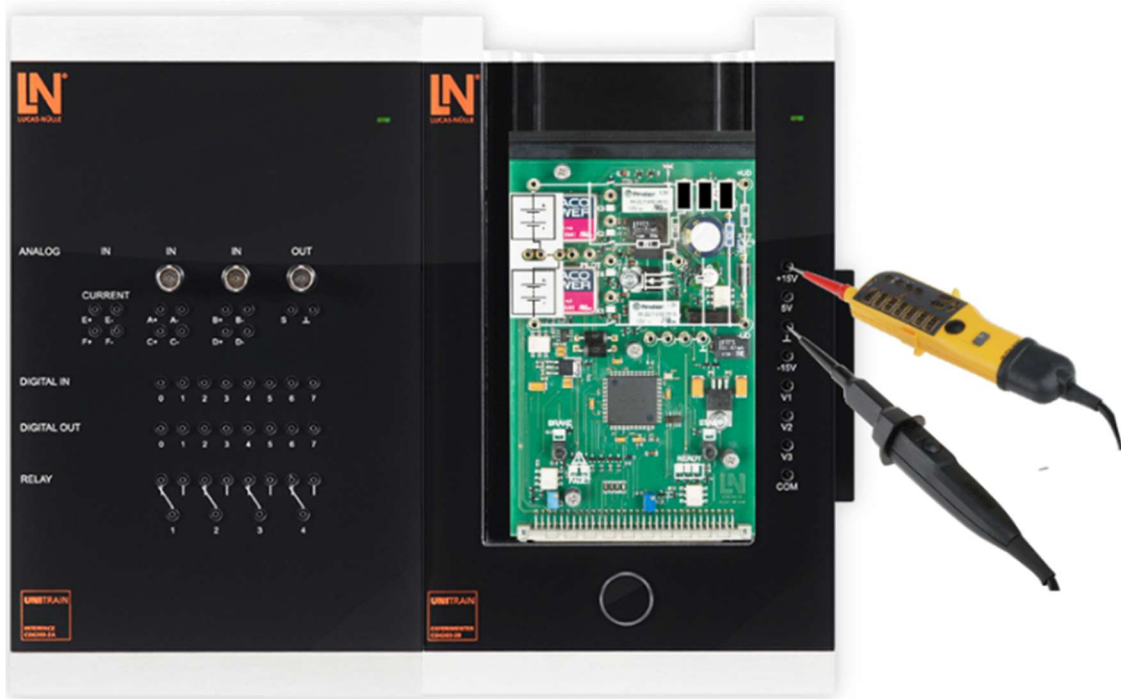
Рис. 5.31. Ізоляція/відключення напруги. Контрольна перевірка справності двополюсного тестера напруги LM8302
