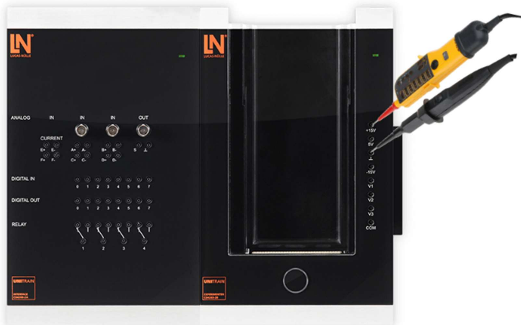
Рис. 5.24. Підключення двополюсного тестера напруги до виводів стенда LN
