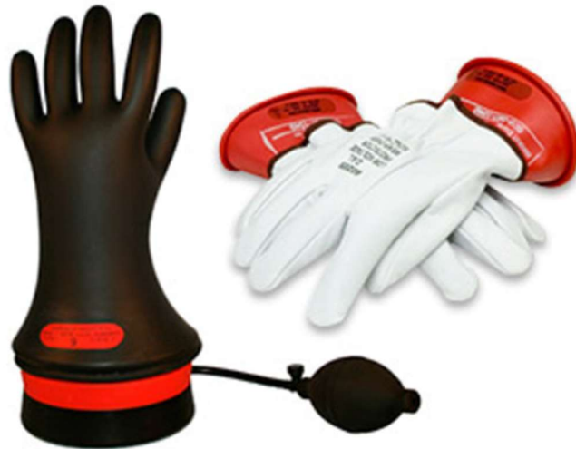
Рис. 5.15. Пристрій для перевірки герметичності захисних рукавичок шляхом надування
