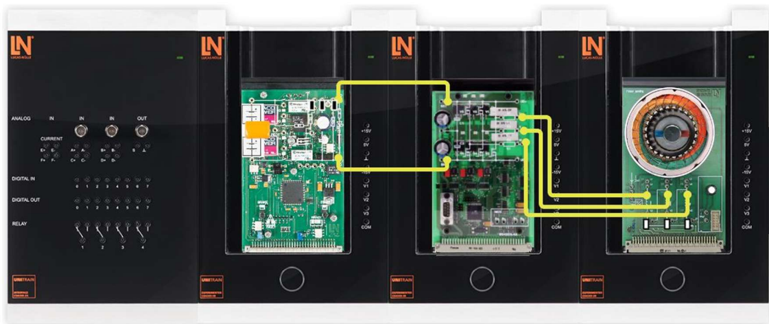
Рис. 4.1. Схема з'єднання стенда LN із ротором з постійними магнітами
