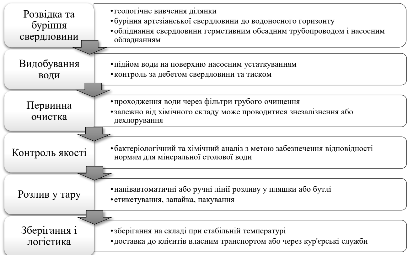
Рисунок 2.1 – Типовий процес видобутку мінеральної природної столової води
