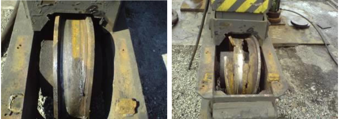
Рисунок 1.2 – Знос кранових коліс: відшарування поверхні катання та деформація реборди (а), руйнування колеса (б)
