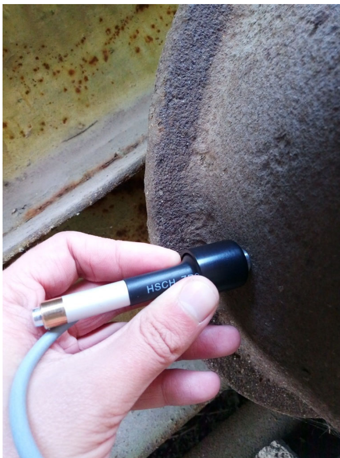
Рисунок 4.4 – Проведення замірів твердості колеса твердоміром Т-УД2
