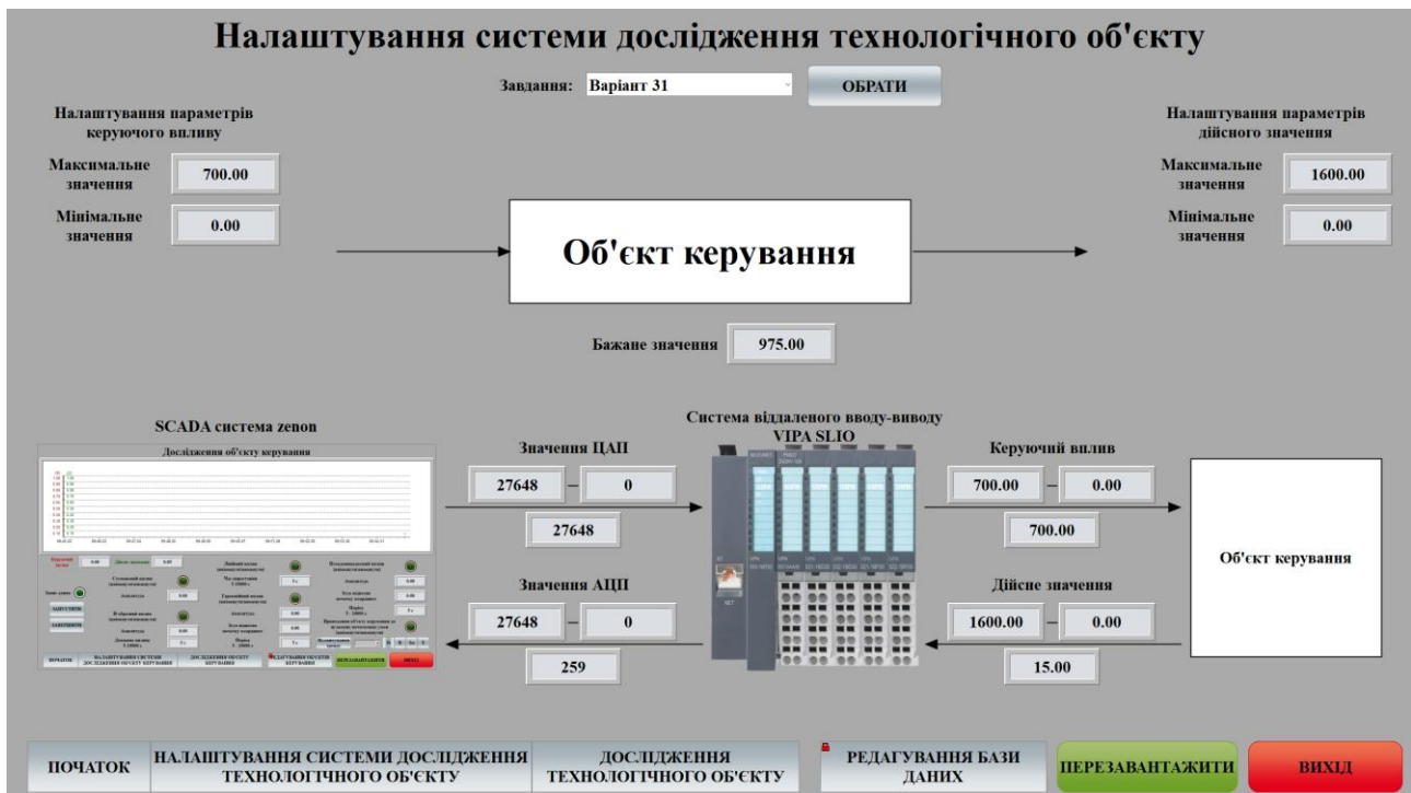
Рис. 3. Екран відображення налаштування автоматизованої системи дослідження безперервних технологічних об'єктів
