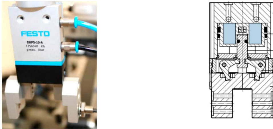
Рисунок 1.14 – Зовнішній вигляд та схема механізму захоплення
