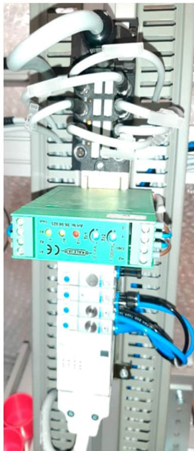
Рисунок 1.4 – Зовнішній вигляд (згори вниз): багатоканальний розподільник, блок контролю швидкості двигуна, пневмоострів
