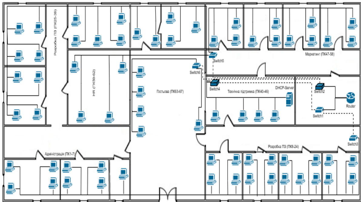
Рисунок 3.20 – Схема фізичної топології корпоративної мережі
