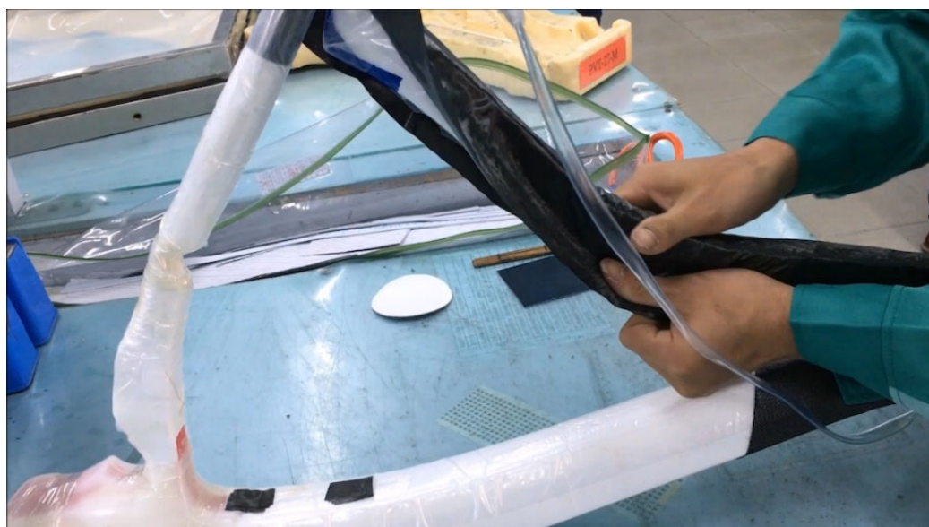
Рисунок 3.4 – Карбон для рами велосипеда накладається на оправлення з пінополістиролу.
