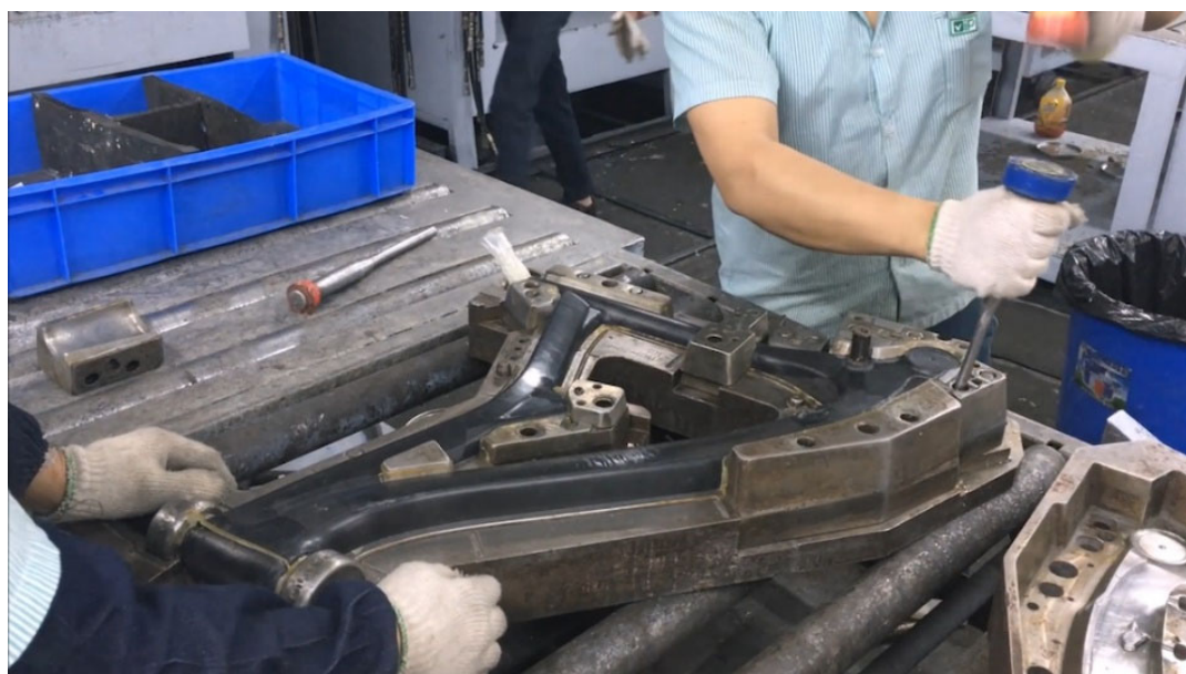
Рисунок 3.6 – Процес виймання готової рами із прес-форми після циклу затвердіння
