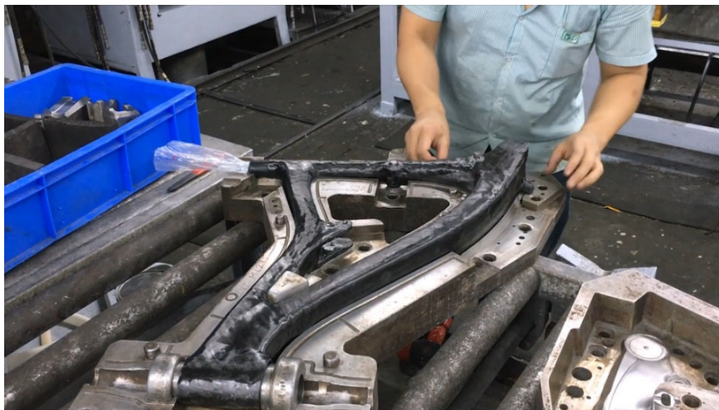
Рисунок 3.5 – М'яка та податлива готова заготовка акуратно поміщається у форму та транспортуються у нагрівальний прес для циклу затвердіння.
