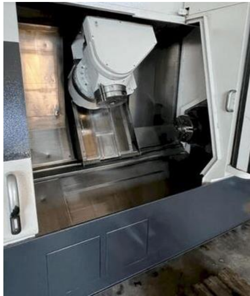
Рисунок 2.10 – Контршпиндель та фрезерна головка MAZAK INTEGREX 200-IV ST [15]
