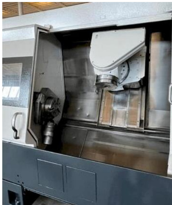
Рисунок 2.9 – Основний шпиндель та револьверна головка MAZAK INTEGREX 200-IV ST [15]
