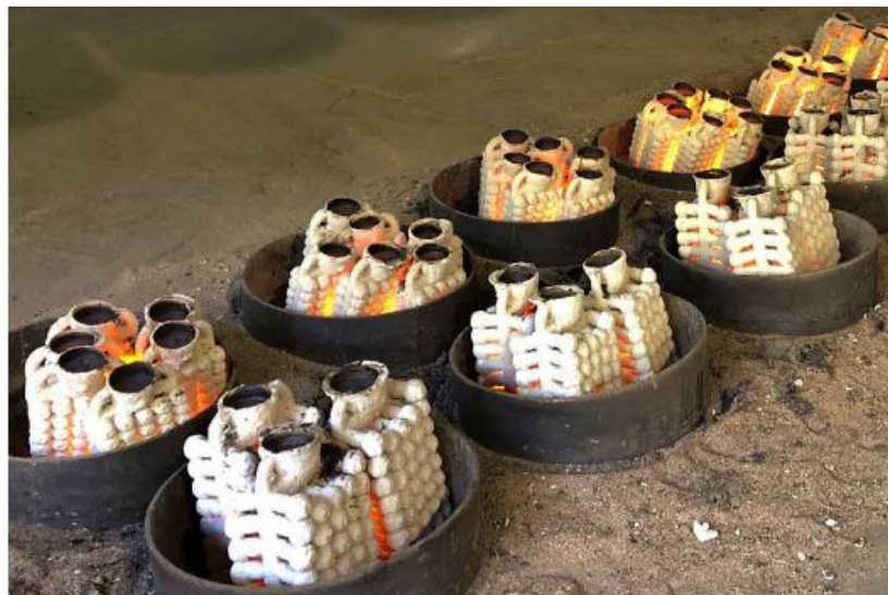
Рисунок 2.3 – Охолодження та затвердіння [13]
