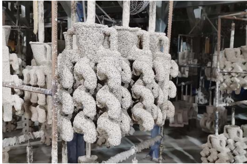
Рисунок 2.2 – Висушування виплавної моделі [13]
