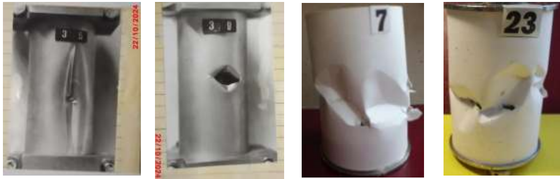
Рисунок 1 – Пошкодження бокової поверхні попередньо розтягнутої оболонки після удару жорстким циліндричним тілом з плоским торцем і малою швидкістю (зліва) та конусною передньою частиною (зправа) і високою швидкістю
