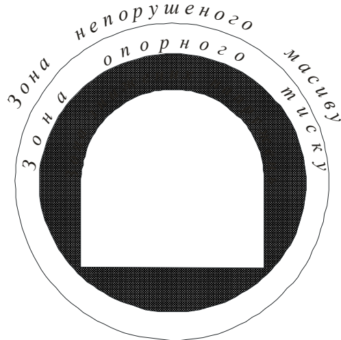
Рис. 1.7. Схема утворення зон напруженого стану при нестійкому стані бокових порід
