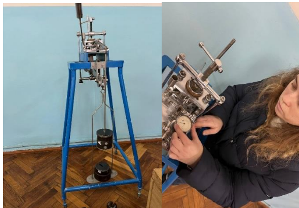
Рисунок 2.6 – Прилад одноплощинного зрізу та процес випробування зразків ґрунту
