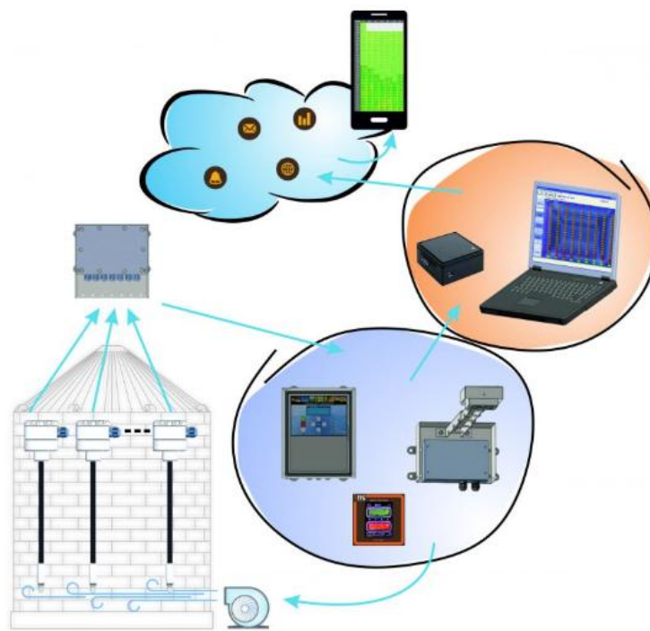
Рисунок 1.6 – Архітектура системи термометрії від компанії IGT [16]
