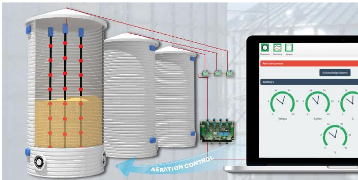
Рисунок 1.5 – Архітектура системи термометрії від компанії Технотест[16]
