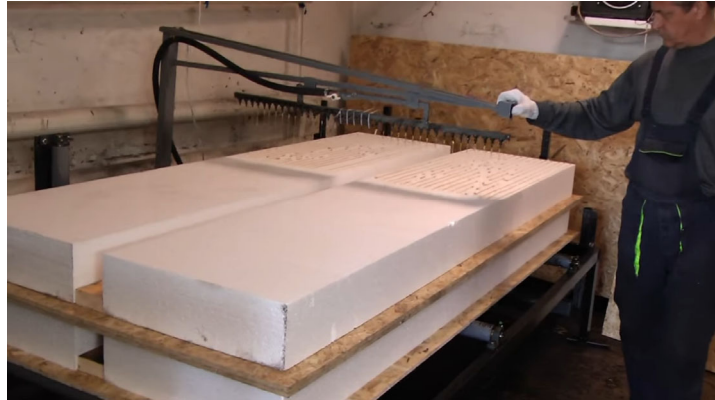
Рисунок 3.2 – Технологічний процес нанесення пінополіуретанового клею на майбутню сендвіч-панель
