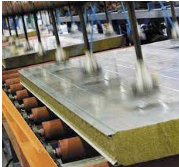
Рисунок 3.4 – Технологічний процес пресування з матеріалом-утеплювачем мінеральної вати
