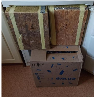
Рисунок 4.4 – Встановлення експериментальних зразків в морозильну камеру: ліворуч – зразок 1 (мінвата 100 мм); праворуч - зразок 2 (мінвата 50 мм з підпокрівельною фольгою)
