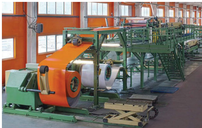
Рисунок 3.1 – Вузол для розмотування сталевих рулонів, обладнаний двома барабанами.
