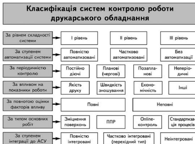
Рисунок 2.1 - Класифікація систем контролю роботи друкарського обладнання.
