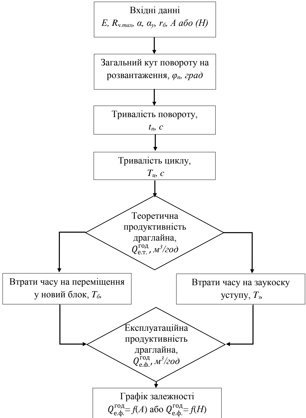
Рис. 4.2. Алгоритм визначення раціональних параметрів вибою драглайна, для досягнення його максимальної продуктивності
