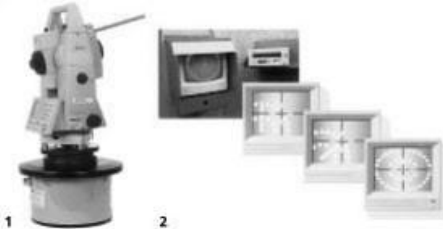
Рис. 4. Лазер для визначення траєкторії руху мікрощіта і лазерна мішень
