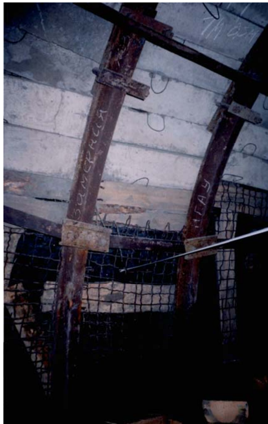
Рис. 4.12. Реперная замерная станция в штреке а) - общий вид; б) - вид слева и в) - вид справа.
