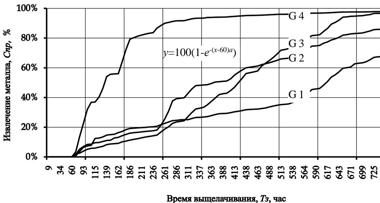
Рис. 1 Скорости выщелачивания урана при различной концентрации кислоты в растворе: G 1: 5 г/л + KCl<sub>3</sub>, G 2: 5 г/л, G 3: 10 г/л, G 4: 20 г/л
