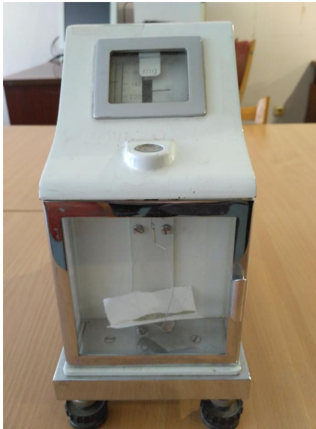
Рисунок 2.2 Сухий залишок, отриманий у результаті випарювання проби води, поміщений на чашку торсійних терезів
