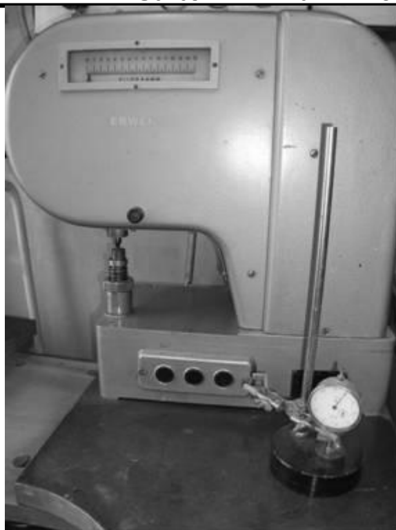
Рис. 1. Прибор фирмы "Erweka" для испытаний экструдатов на прочность при сжатии
