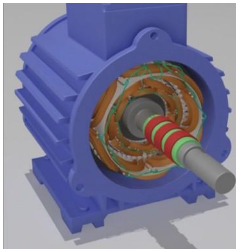
Рис.1. Фрагмент мультимедийного сопровождения одного из этапов сборки асинхронного двигателя с фазовым ротором
