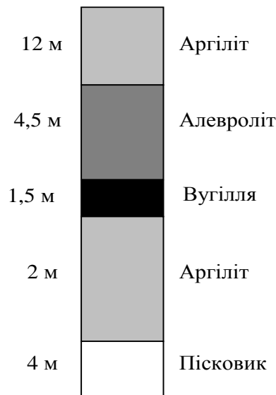
Рис. 1.5. Структурна колонка пласта k_7
