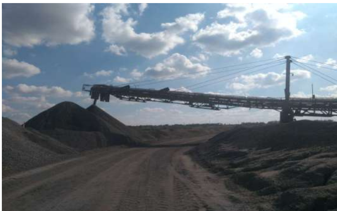
Рисунок 2.1 Робота консольного відвалоутворювача
