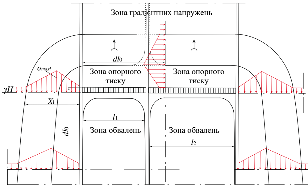
Рисунок 1 – Ескізне відображення спарених очисних вибоїв при положенні 0-0 (здвоєна лава): X_i – змінна величина поширення зони опорного тиску, м; dl_0 – половина довжини спарених лав, м; l_1 ; l_2 – довжини лав; \sigma_{maxi} – змінна величина максимуму загальних напружень
