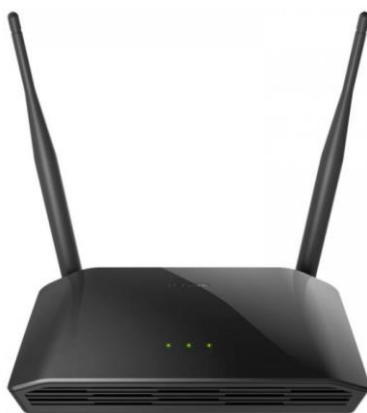
Рисунок 3.8 - Бездротовий маршрутизатор D-Link DIR-615 / T4 (N300, 4xFE LAN, 1xFE WAN, 2 антени)
