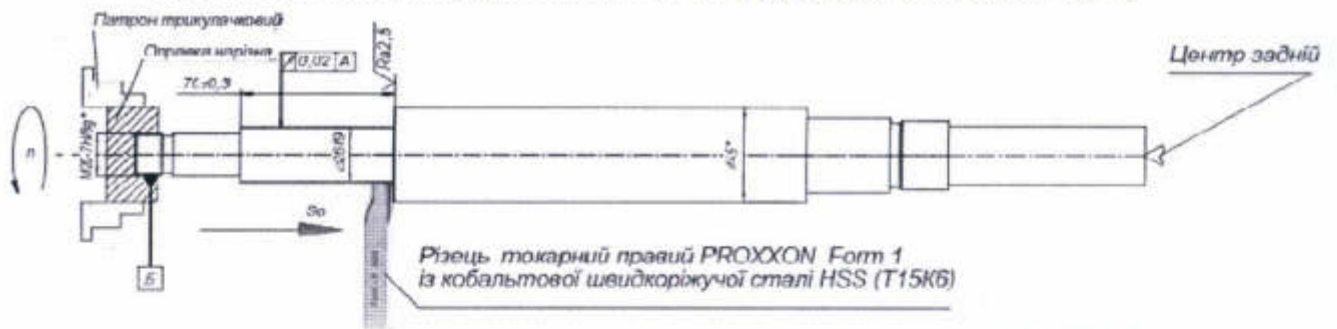
15. Точити начорно, чисто, тонко поверхню \varnothing 26f9 (-0,025 / -0,057) , витримуючи розмір 70 \pm 0,3
