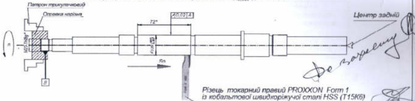
20. Точити начорно, чисто та тонко поверхню \varnothing 32f9 (-0,025 / -0,057) , на довжині 72*
