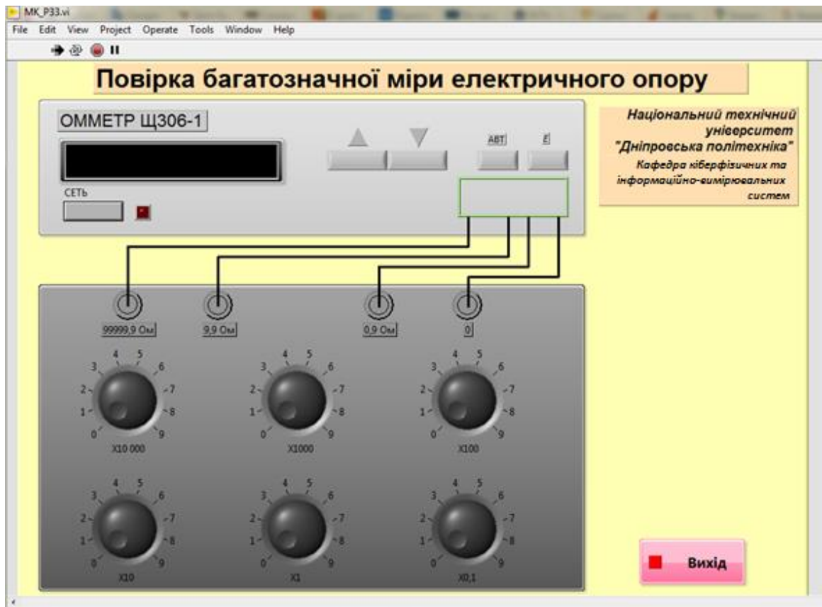
Рисунок 1 – Лицьова панель віртуального приладу для виконання повірки БМЕО
