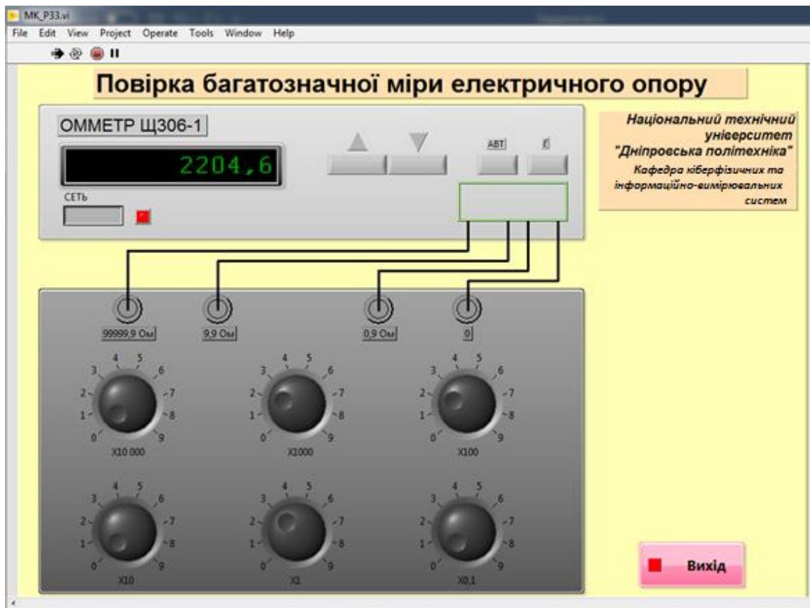
Рисунок 1 – Лицьова панель віртуального приладу для виконання повірки БМЕО
