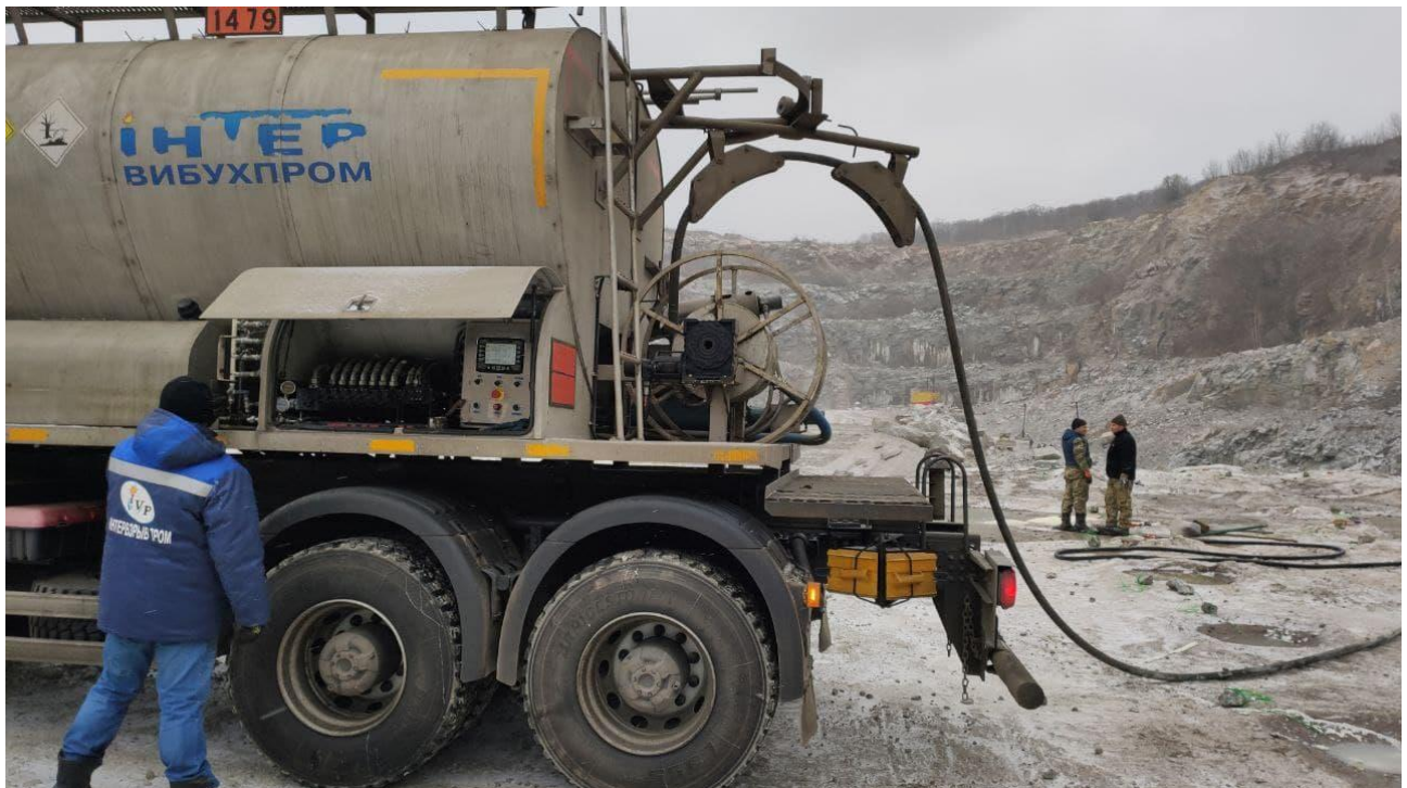
Рис. 3.2 Зарядна машина в процесі зарядження вибухового блоку
