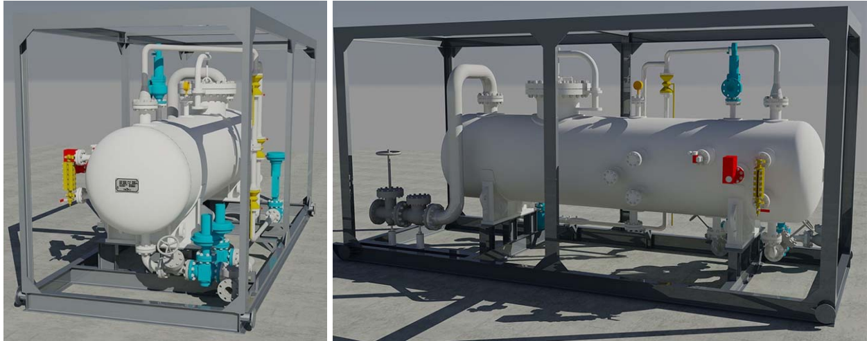
Рисунок 1.7 – Сепаратор поділу і збагачення супутнього нафтового газу типу СУ-200
