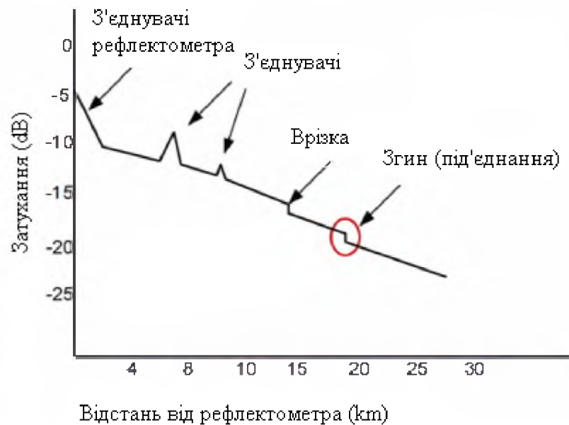
Рисунок 2.6 – Пошук підключення на оптичній трасі за допомогою оптичного рефлектометра
