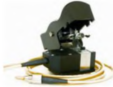
Рисунок 2.4 – Волоконно-оптичного відгалужувача-прищіпки моделі FOD-5503
