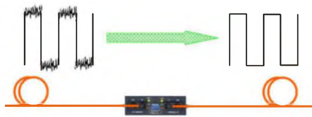
Рисунок 2.15 – Форма відфільтрованого акустичного сигналу за допомогою медіаконвертора
