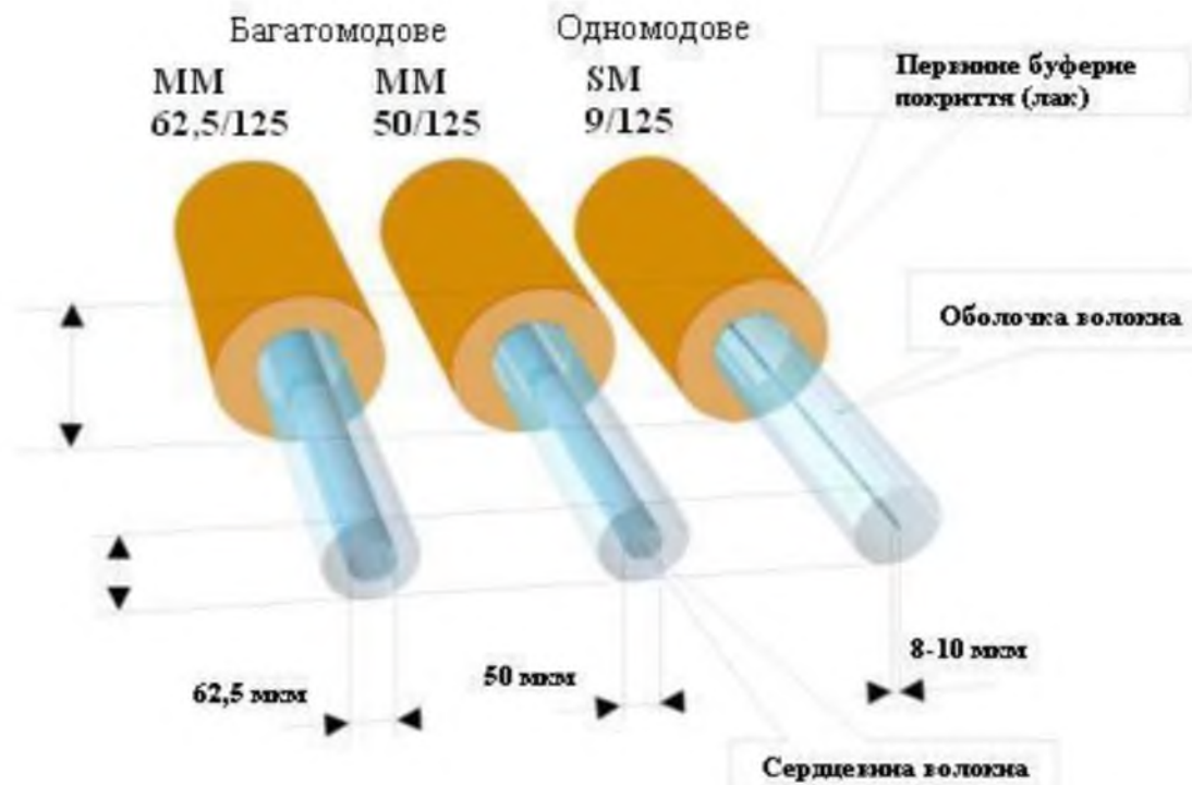
Рисунок 1.6 – Конструкція одномодового и багатомодового волокна
