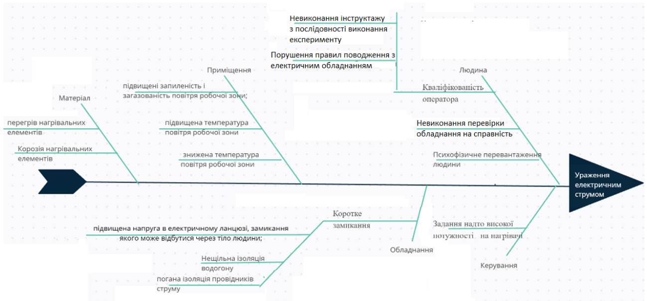
Рисунок 5.1 – Діаграма Ішікави, яка відображує фактори, що можуть призвести до ураження електричним струмом.
