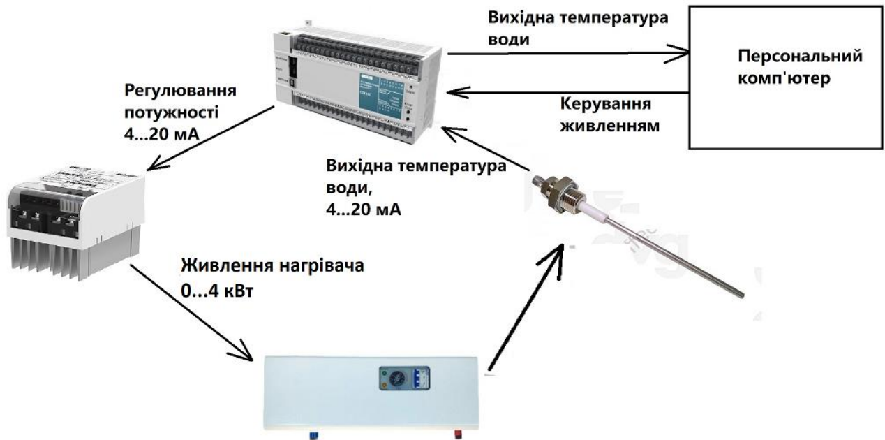
Рисунок 3.1 – Структурна схема інформаційних потоків дослідницької системи
