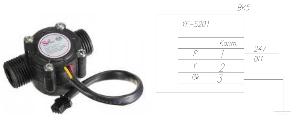
Рисунок 2.5. – датчик витрат YF-S201: а) загальний вигляд; б) схема підключення датчика витрат YF-S201 до програмованого логічного контролеру ПЛК160
