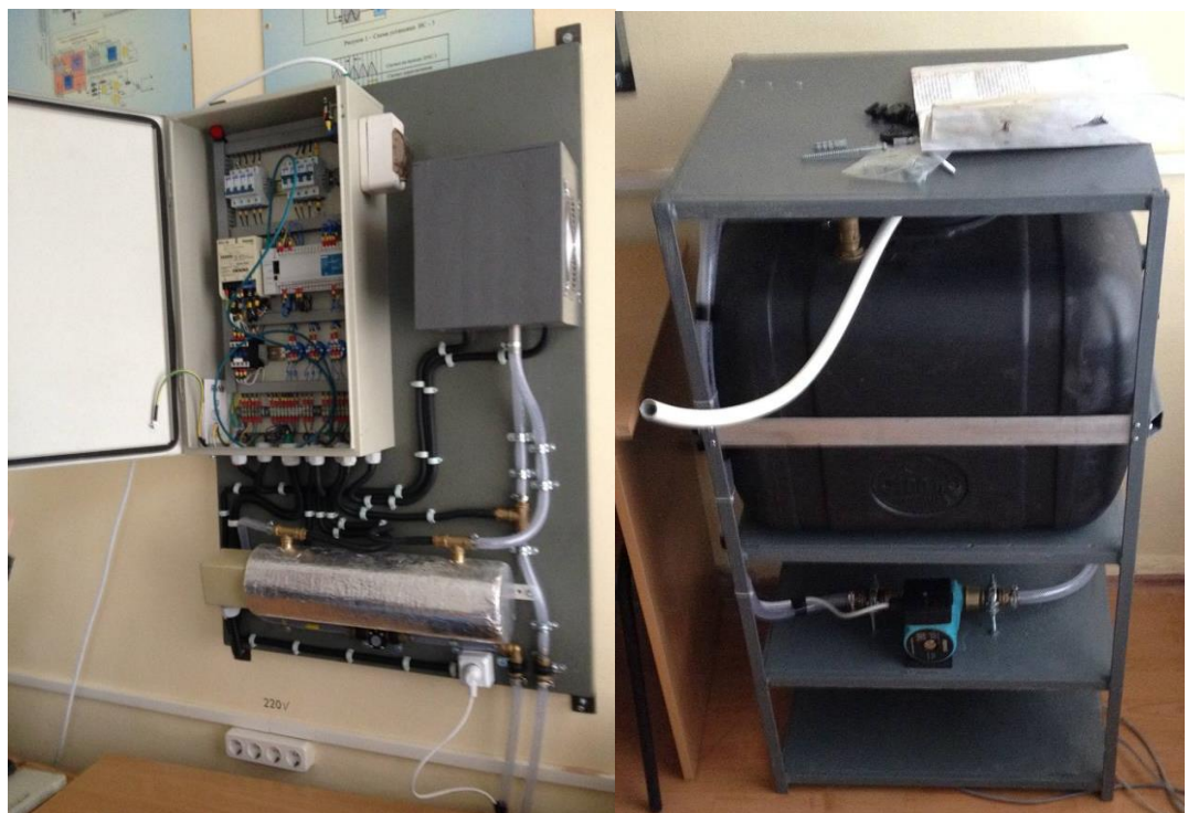
Рис. 1.1 – стенд для дослідження питомих витрат електроенергії при різних режимах нагріву води і конструкцій нагрівачів
