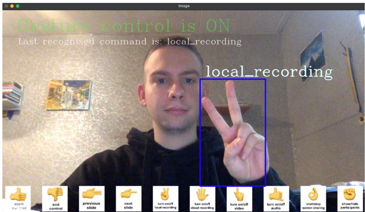
Рис. 3.6. Інтерфейс програми у разі показу користувачем жесту, що відповідає за початок/кінець локального запису відеоконференції
