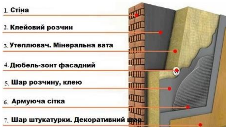
Рисунок 1.1 - Технологія утеплення стіни мінераловатними матами
