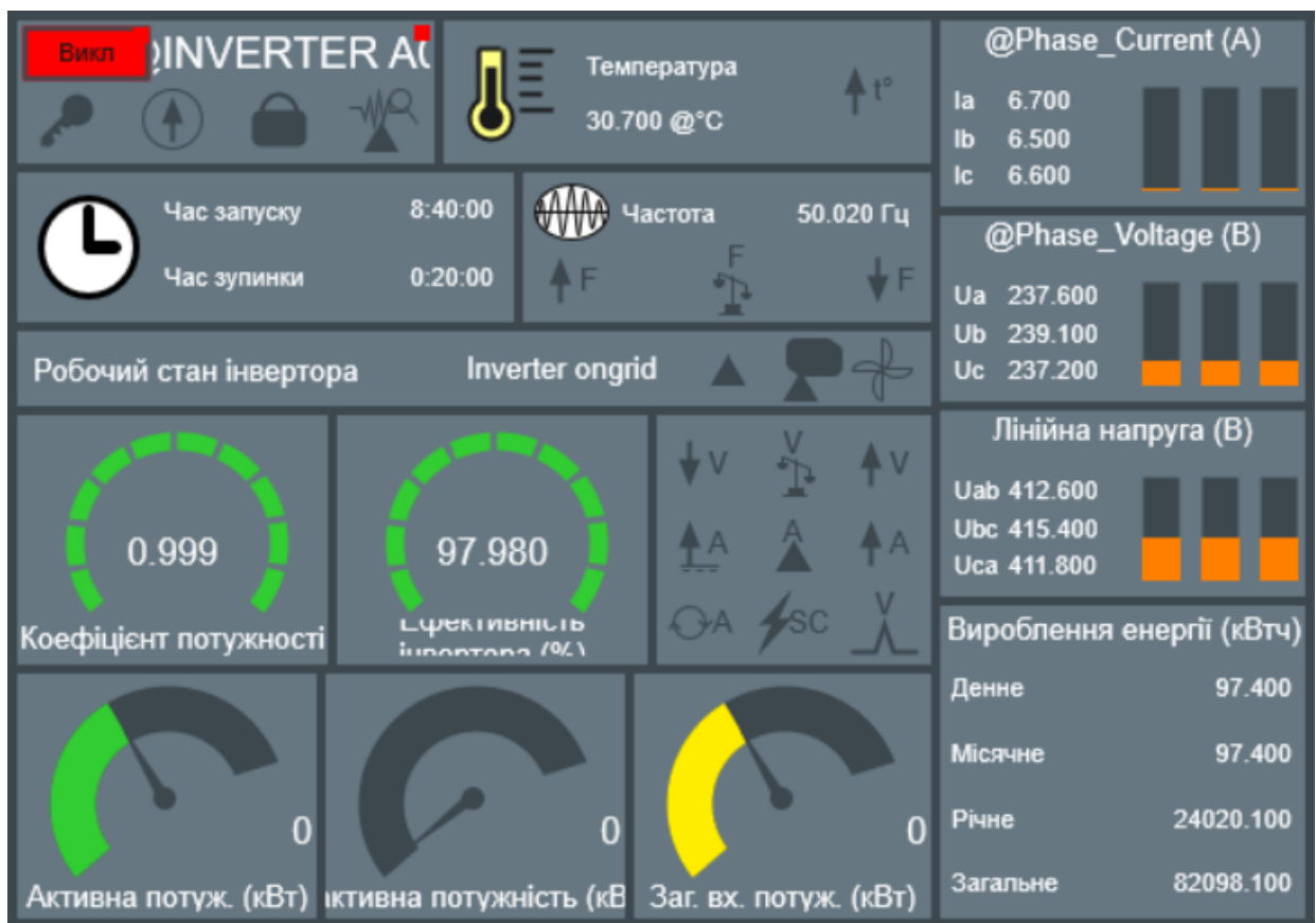
Рисунок 2.6. Екран параметрів інверторного обладнання
