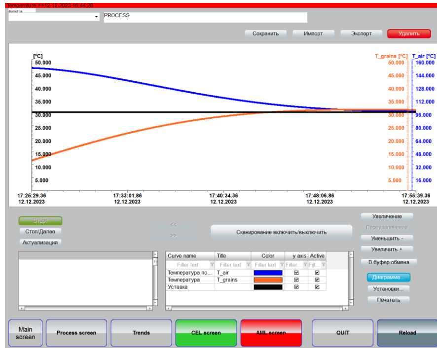
Рисунок 4.23 – Зображення моніторингу зміни температури нагріву зерна у зерносушарці
