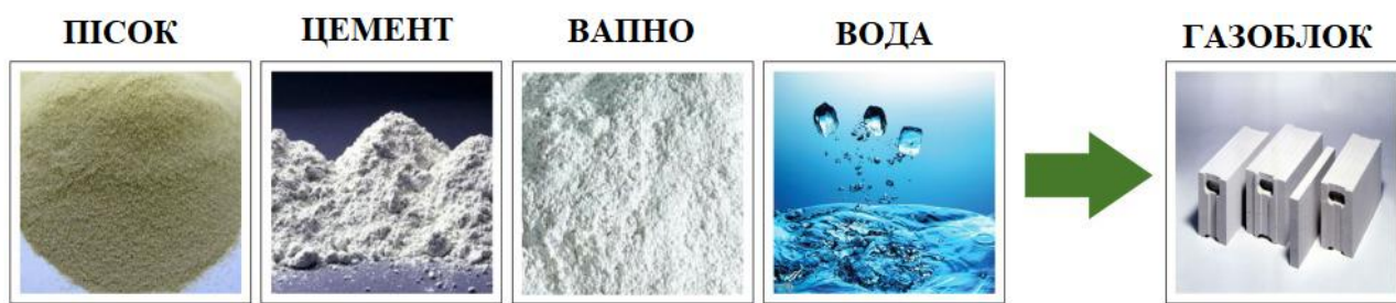
Рисунок 1.2– Спрощена послідовність виробництва газобетону
