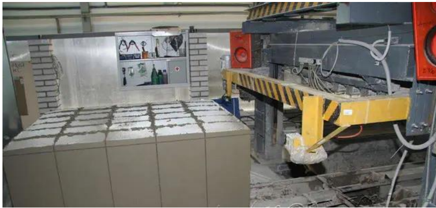
Рисунок 1.5 – Комплекс для різання газобетону
