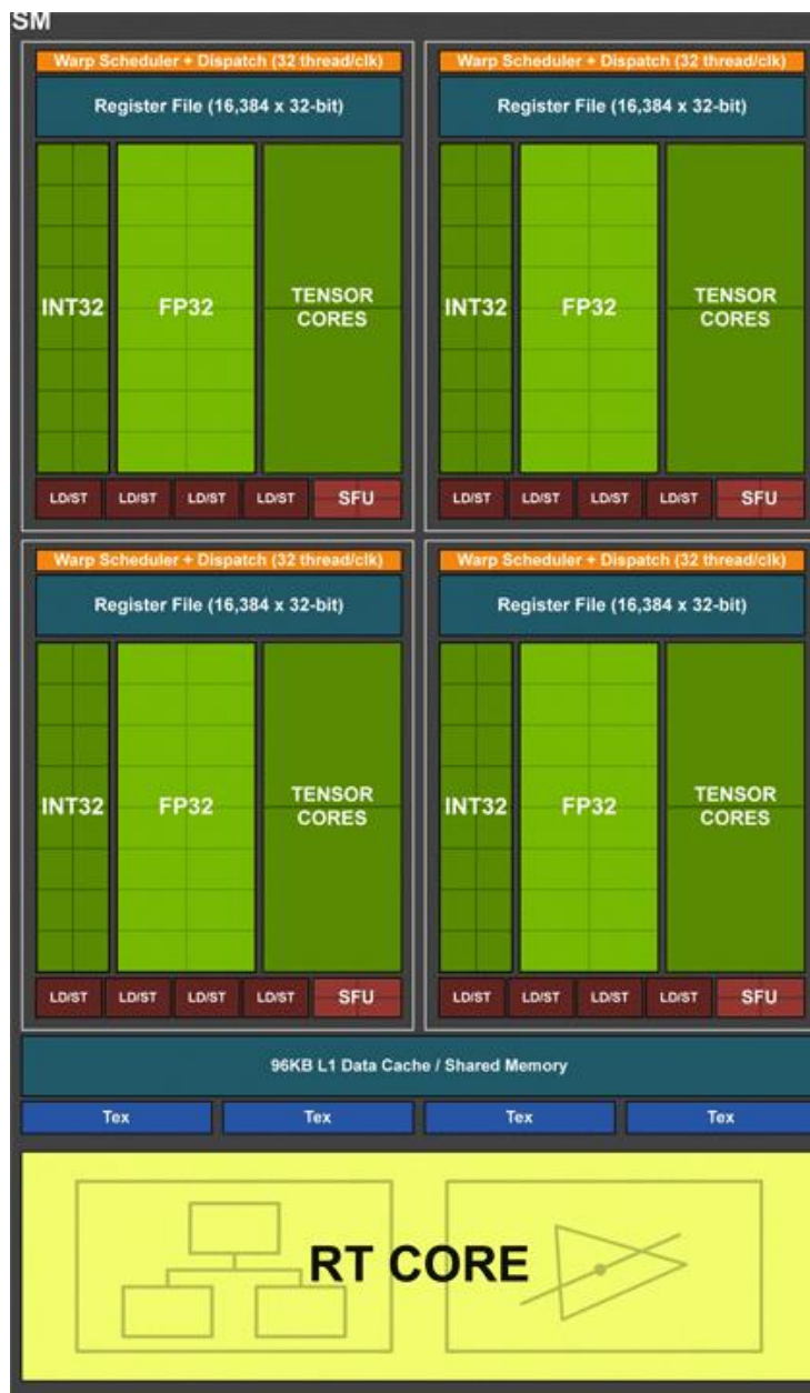
Рисунок 4.7 – Структура блока SM архітектури Turing.
