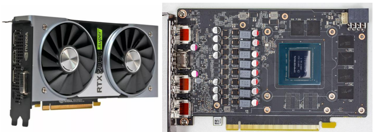
Рисунок 4.5 – Зображення графічного прискорювача TU106(RTX 2060S).
