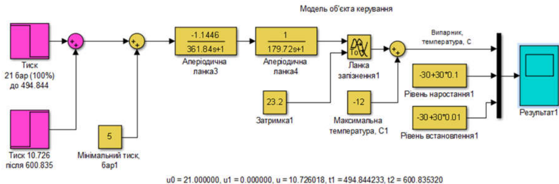
Рисунок 2.12 – Імітаційна модель для визначення мінімального часу наростання та встановлення (оптимальний регулятор)
