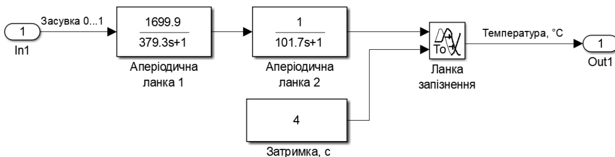
Рисунок 4.2 – Безперервна модель об'єкта керування
