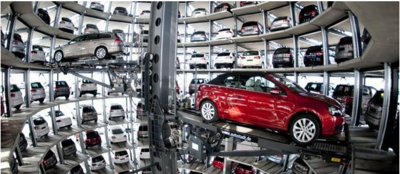
Рис. 6.2 – Автоматизована схема доставки автомобілів у вертикальній та горизонтальній площинах до місць стоянки
